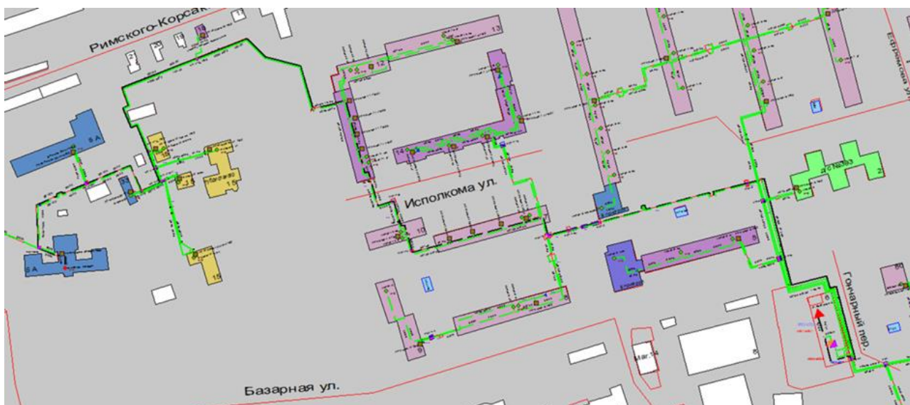
Рисунок 3.55 – Трассировка теплопровода от котельной АО «Теплоэнерго» «9 МР Сормово» по ул. Базарная, д. 6 до конечного потребителя «ПТ-В.Рев,5а УФССП»
