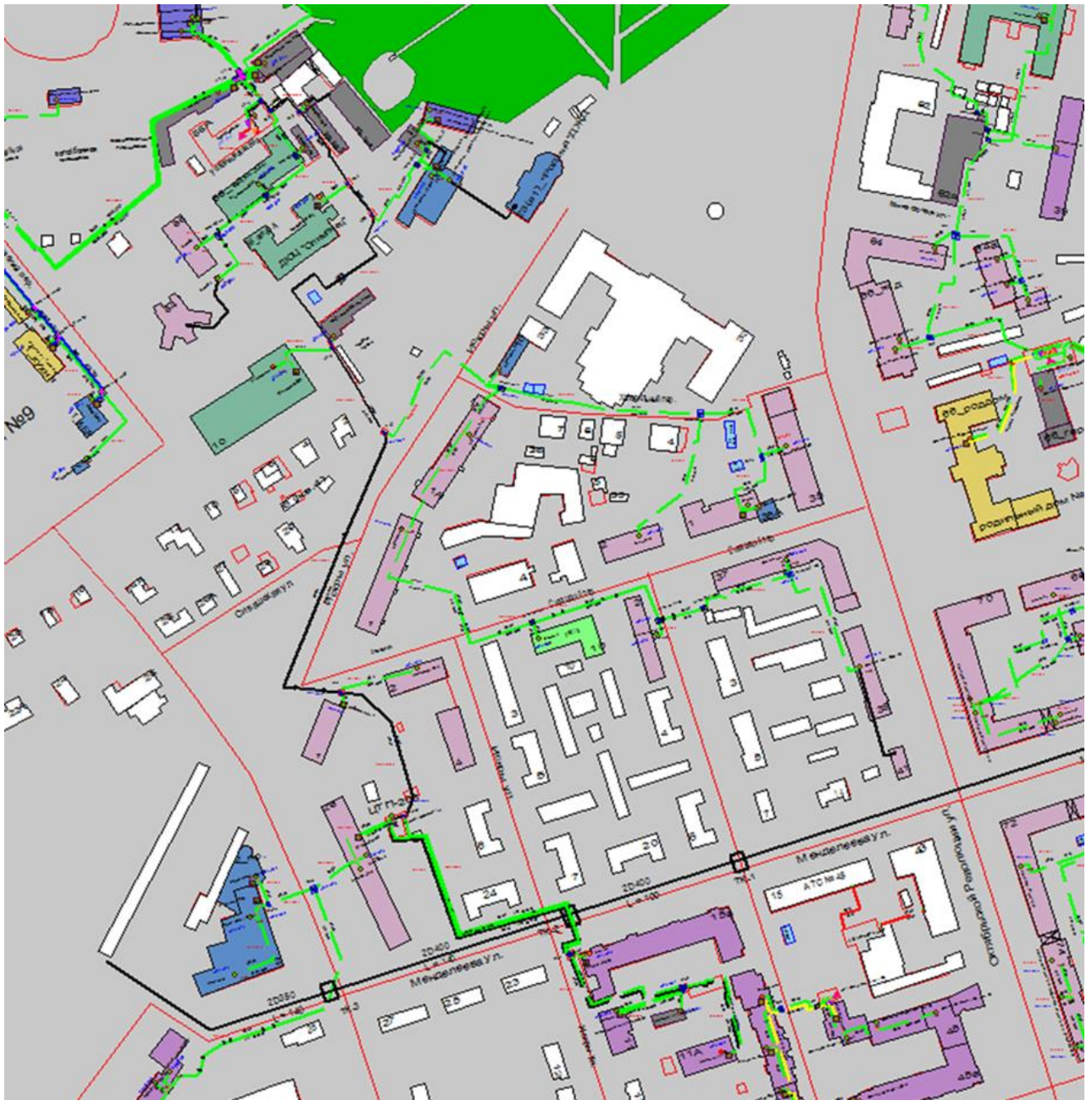
Рисунок 3.37 – Трассировка теплопровода от котельной АО «Теплоэнерго» по ул. Климовская, д. 86А до конечного потребителя «ПТ-Искры,11а»
